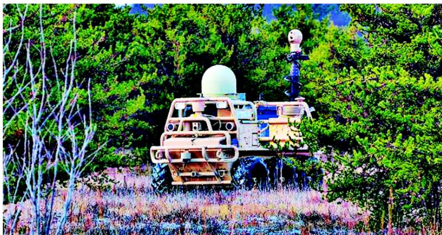
ход поддержки пехоты» (Squad Mission Support System) представляет собой беспилотное транспортное средство длиной 3 м с шестью колесами, — сообщают разработчики. — Полутоннажная машина может перевозить 550 кг нагрузки на расстояние до 200 км. Набор датчиков позволяет ему следовать по заранее определенному маршруту и тем же маршрутом возвращаться.
