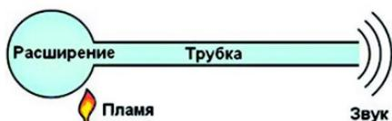
Схема «трубки Зондхауса».
